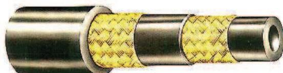
Popis: hadice HW 2SN podle EN 853: 1996 (dříve DIN 20 022) používaná v hydraulických zařízeních k dopravě především ropných a hydraulických olejů při teplotě od -40 °C do +100 °C a pracovním přetlaku stanoveném technickou normou. Elektrický odpor hadice je nejvýše 1,10<sup>6</sup> Ω. Hadici lze použít jako součást elektrostatického svodu. Hadice HW 2SN má vnitřní a vnější vrstvu z pryže černé barvy a výztuž dvěma oplety pomosazeným drátem.
