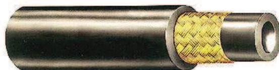
Popis: používaná v hydraulických zařízeních k dopravě především ropných a hydraulických olejů při teplotě od -40 °C do +100 °C. Hadice má vnitřní a vnější vrstvu z pryže černé barvy a výztuž jedním opletem pomosazeným drátem.
